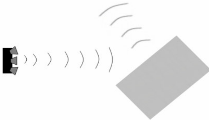
Rys. 9 Przykład błędnego działania czujnika – odbity sygnał nie dociera w pole „widzenia” odbiorników
