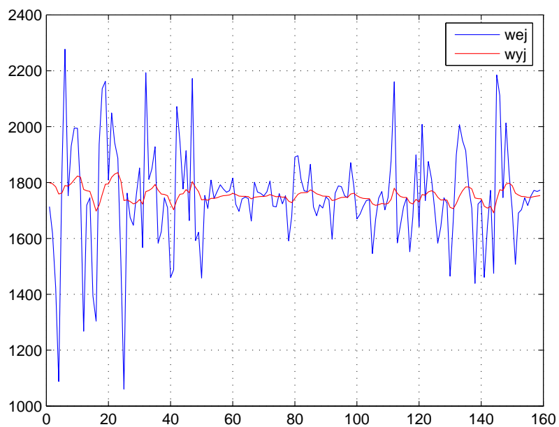
Rysunek 12: Pomiar napięcia dla wariacji R = 0,001 i Q = 10e - 5 .
