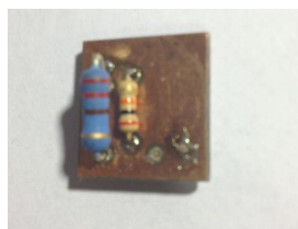
Rysunek 8: Widok czujnika odbiciowego od góry.
